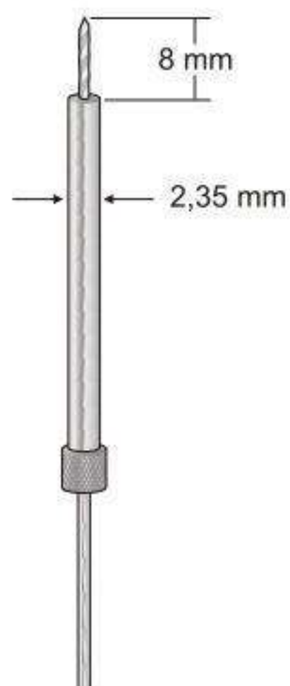
Special Drill Spezialbohrer Ø 1,7 mm
